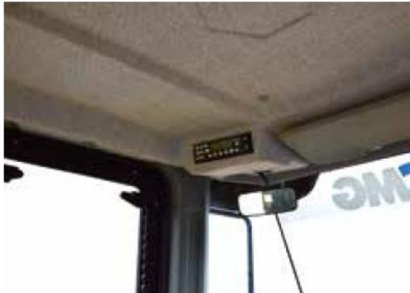
El exquisito revestimiento interior y las medidas de amortiguación y reducción del ruido de la cabina y el capó del motor reducen el ruido en más de 6dB para cumplir la norma europea de ruido interno de la cabina y creando un entorno operativo confortable.
